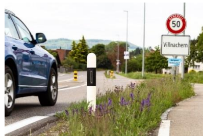
Zählgerät als Leitpfosten
